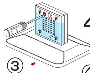
4. Fixer les cylindres réservoirs d'hydrogène et d'oxygène sur leur socle (les insérer, puis les tourner dans le sens des aiguilles d'une montre pour les fixer). Les remplir d'eau distillée jusqu'à la graduation « 0 ».
